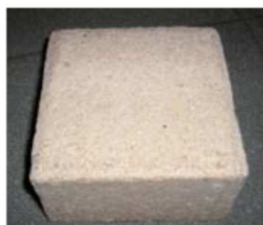
Pavés en béton poreux
